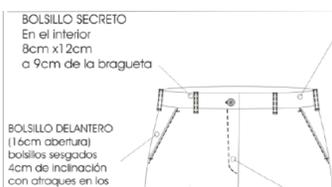
PRETINA Ancho de 4cm con forro interior (Bramante) De dos piezas con 02 botones (externo e interno), 02 ojales cinta antideslizante, LONA, BAN ROLL
